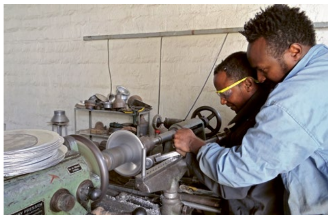
Metalldrücker Tsegay (rechts) instruiert einen Arbeiter auf der Jenni-Drückbank
